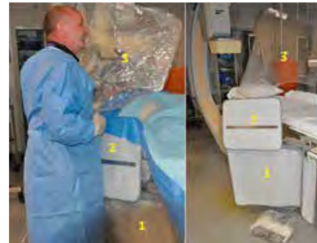
Figuur 1. Loodscherm 1 en 3, resp. gefixeerd aan de tafel en het plafond worden routinematig gebruikt. Het is echter ook van belang loodscherm 2 te gebruiken, gezien dit ook leidt tot een significante dosisreductie (discussie punt 6.)
